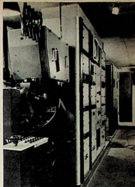
Bild 2. Vorn Sendeeinrichtung für 35-mm-Film mit Mechau - Projektor, dahinter die doppelt vorhandene Impulszentrale und Bildkontrollgeräte in den Studiordümen
